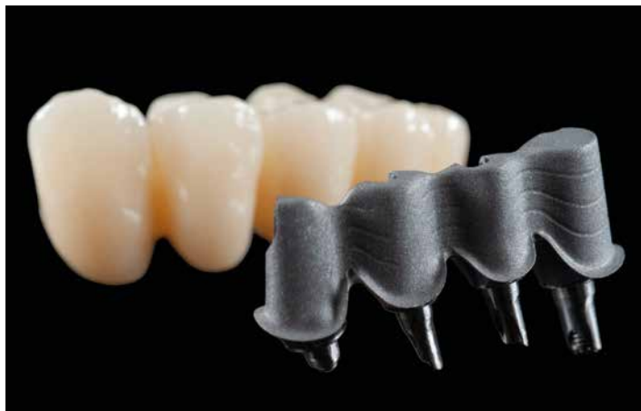
Abb. 8 Vor dem Fügen: Zirkonbrücke und Titansteg als getrennte Teile.
