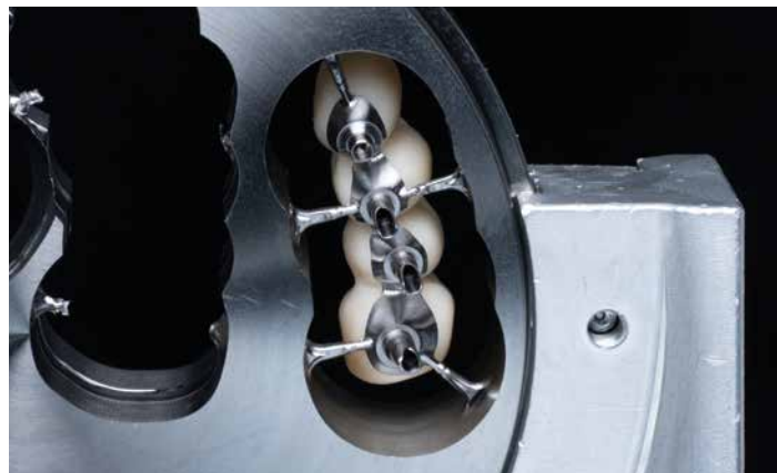
Abb. 6 Passungskontrolle direkt aus der Maschine: Die Brücke sitzt auf dem Steg, während dieser noch im Blank hängt.
